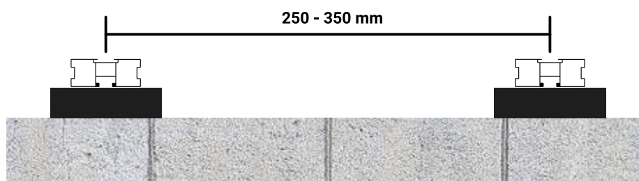
Separación entre rastreles
