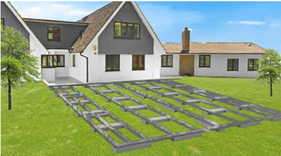
Estructura de rastrelado con losetas
