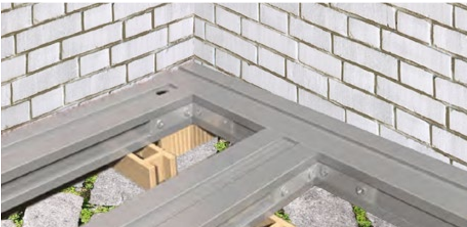
Unión de rastreles mediante escuadras
